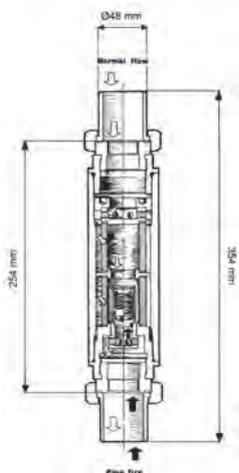
El FR63 esta diseñado para proteger grandes redes de acetileno, instalaciones y usuarios. Su gran capacidad permite limitar las caídas de presión y obtener rendimiento, caudales importantes y aplicaciones oxiacetilénicas seguras con soplete de inyector o de presión positiva.
